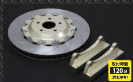
4 フロントドライブシャフトブレイクローターブラケットセット (前期、後期)
